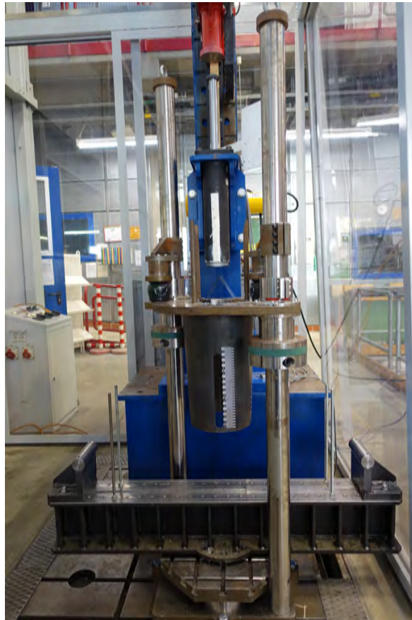
Abbildung 5.2.: Bild vom Aufbau des Prüfstandes im dynamischen Drei-Punkt-Biegeversuch
